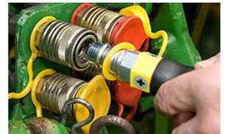
2. Auf der anderen Seite des ÖldruckMaster Systems ist eine spezielle Kupplungsmuffe ( auf dem Foto mit Kennzeichnung grün - ). Der unter Druck stehende Hydraulikschlauch wird mit dieser Kupplungsmuffe verbunden.
