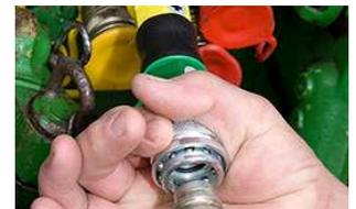
3. Ein kurzer Druckimpuls vom Schlepper öffnet den unter Druck stehenden Kupplungsstecker am Hydraulikschlauch. Ventil auf Senken stellen, der Druck im Schlauch ist sofort abgebaut.
