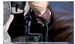
4. Beim Abziehen des Hydraulikschlauches aus der Kupplungsmuffe ist eine geringe Ölleckage nicht zu vermeiden ( wie bei Schlepperkupplungen ohne Ölrückführung ).
